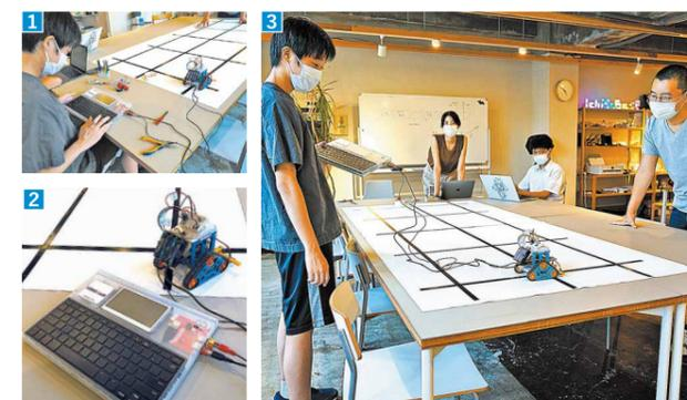
1 碁盤の目状に黒いテープを貼り、目的地の交差点で正確に止まるようプログラミング。少しだけアドバイスをもらい、6000文字からなるプログラムを自力で書き上げた 2 今回プログラミングで使用したのは単三電池4本で稼働する「IchigoDyhook(イチゴダイフック)」と、拡張性が高いTAMIYA社製ロボット 3 中学の数学知識で可能なプログラミングだが、メンバーからの「絶対座標のポイントに行くように設定するには」という発言にはプロもうなる
