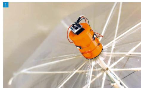
1 完成したデモ機を、傘をさす(上に向ける)と点灯し、閉じる(下に向ける)と消えるというプログラムに改良しさらに便利に 2 試行錯誤の痕跡。3Dプリンターで量産が可能
